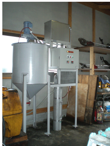
バイオ燃料生成装置 日量200L
