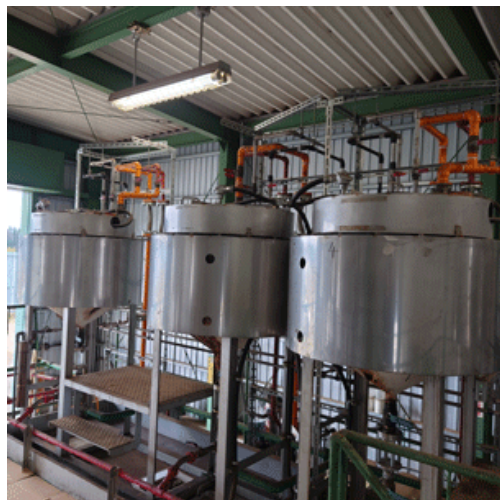
バイオ燃料生成装置 日量600L
